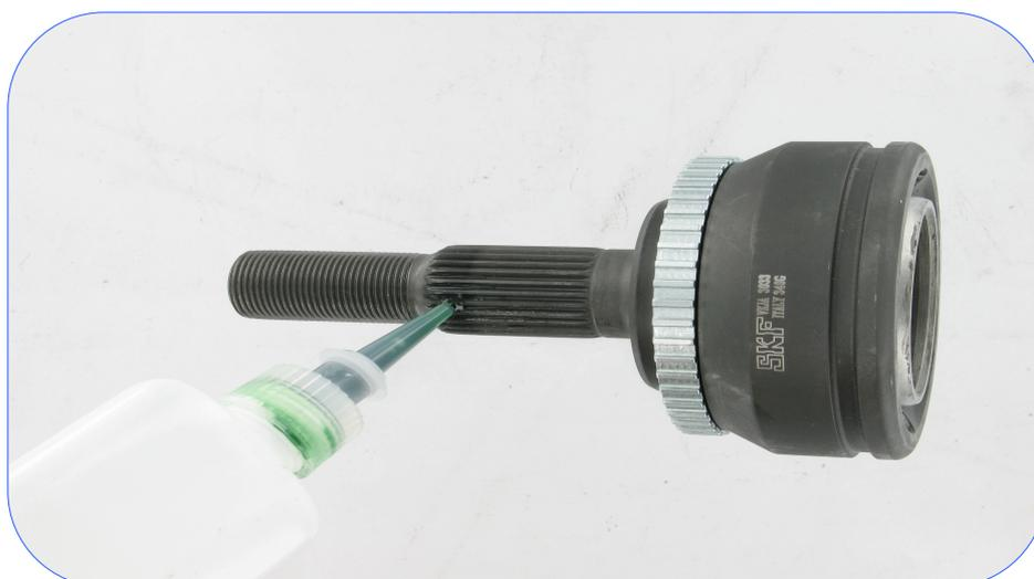
Imagen 1: aplicación del pegamento para metal
