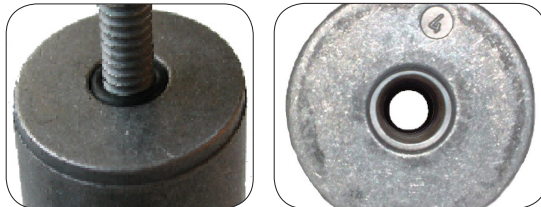
Imagen 3 y 4: junta tórica en posición correcta sin holgura.
