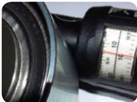
Imagen 8: llave dinamométrica. La imagen es solo como referencia.
