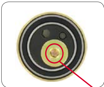
Imagen 10: a continuación, apriete el tornillo de apriete del tensor un total de 4,2 daNm (42 Nm).
