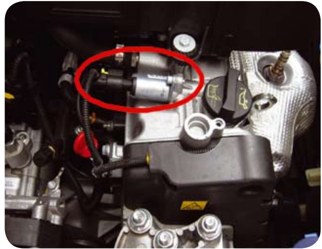
IMAGEN 2 con electroválvula del variador de fase
